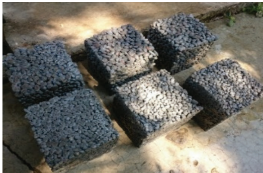
ภาพที่ 2 ตัวอย่างแท่งคอนกรีต
